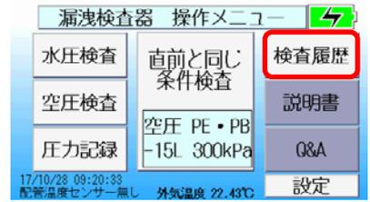
1. 漏洩検査器 操作メニューの検査履歴を押します。
