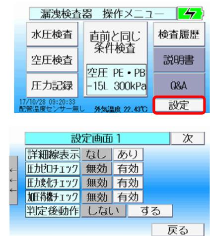
センサーケーブルの不良や、センサー故障など、自然には発生しないような急激な圧力変動をエラーとする機能の有効無効を選択します。
