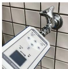
※ホーム水栓アダプターを使用しない場合は、付属のオーリングアダプターが接続できる1/2サイズのネジを使って接続し、検査できます
